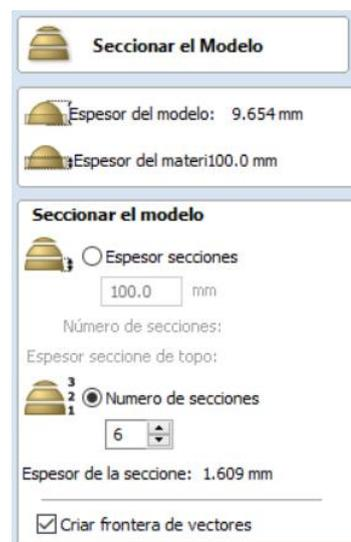
En cuanto a las secciones existe la opción de introducir el espesor de los mismo o introducir el número de secciones y la altura será calculada automáticamente.
