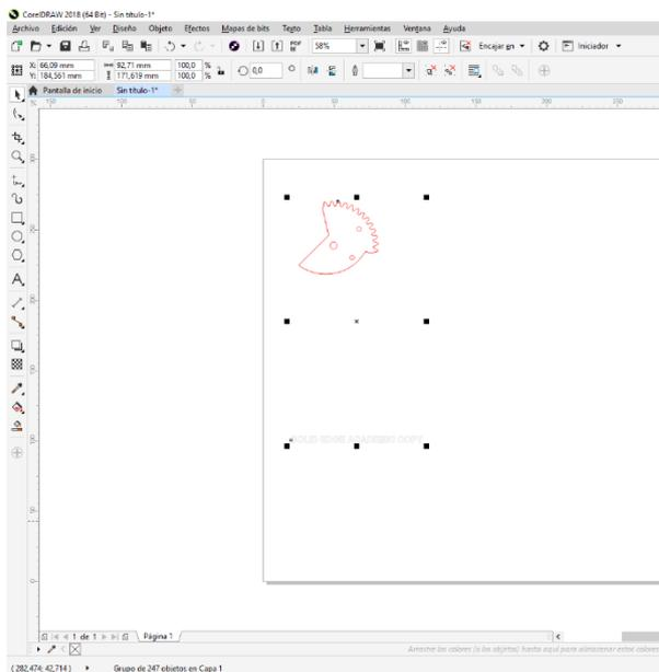
Puede crearse directamente la pieza en CorelDraw sin tener que elaborar un 3D, manteniendo un grosor de línea de 0,1 mm.
