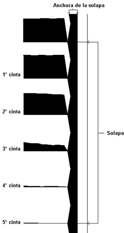
Fig. 7.10-8: Ejemplo para cintas por solapa, la anchura de la solapa y las cintas
